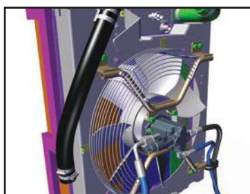
Ventilateur à commande hydraulique
